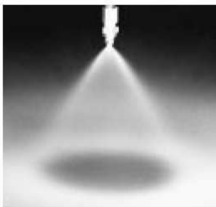
Obr. 31 – Tryska TX.60 se zobrazením rozstříku
