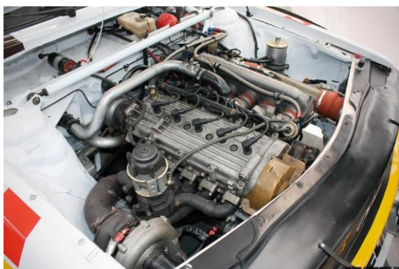
Obr. 14: Motor závodního vozu Audi Quattro S1 s velkým turbodmychadlem [ https://www.flickr.com/photos/aaron_fernandez/6038635650/ ].
