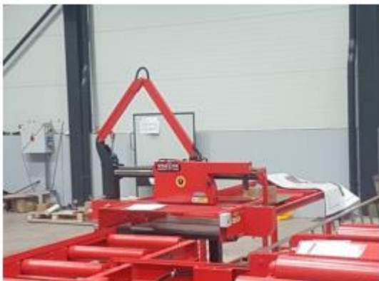
Obrázek 28: Kotoučová zkracovací pila WRAVOR TYP 1000 W.
