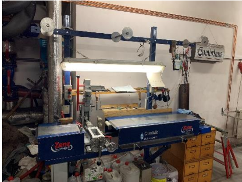
Obrázek 14: Válcovací stroj pro pilové pásy značky ZENZ.
