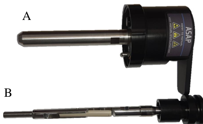
Obrázek 7: Sonda ASAP, pevně instalovaná část (A), odnímatelná část (B)
