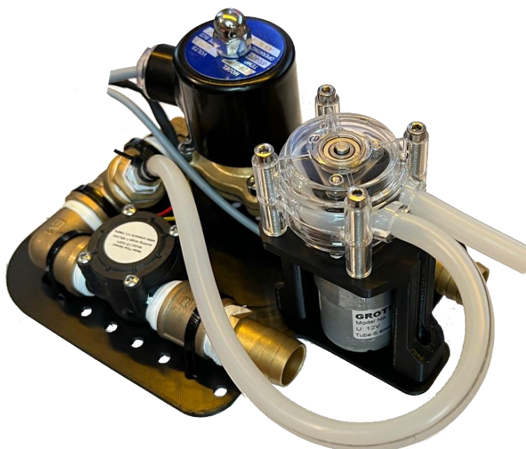
Obrázek 11 Ukázka kompletního kapalinového mechanismu (vlastní)
