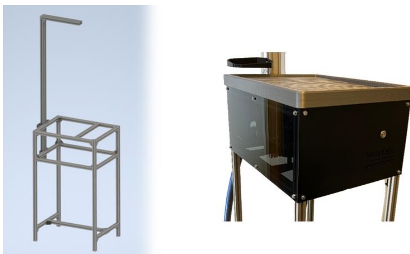
Obrázek 4 Návrh konstrukce v AD Inventor a finální podoba předního panelu (vlastní)
