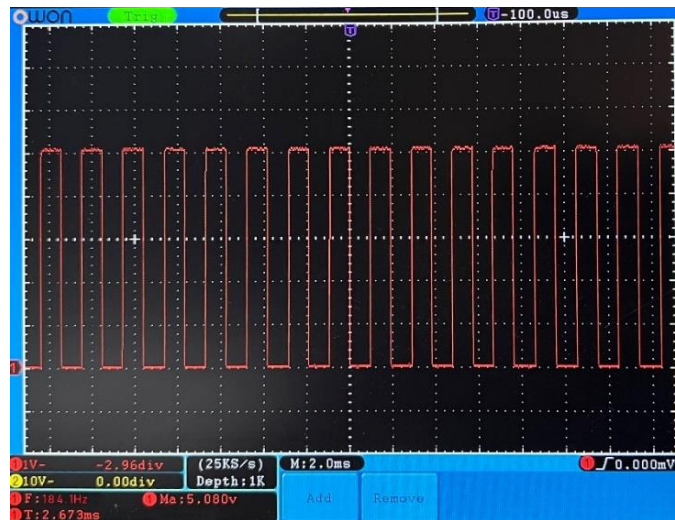
Obrázek 18 Analýza výstupního signálu průtokoměru pomocí osciloskopu (vlastní)
