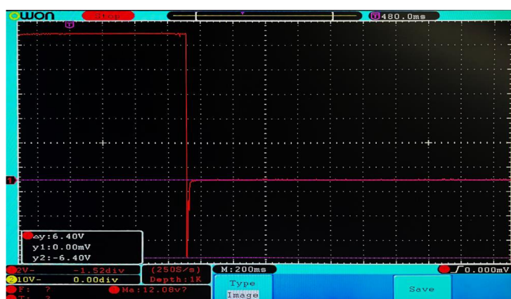
Obrázek 23 Měření napěťové špičky při odpojení ventilu pomocí osciloskopu (vlastní)
