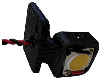
Obrázek 7 Realizace LED osvětlení (vlastní)
