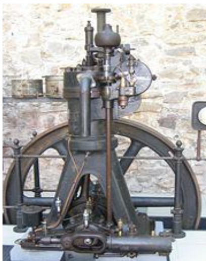
Obr. 2 Dieselův motor z roku 1897 [12]
