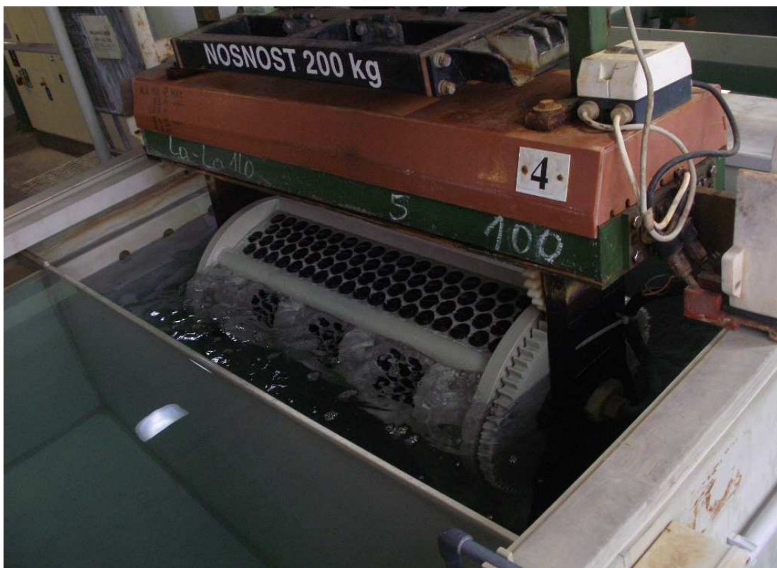
Příloha 6: Buben se zbožím ve dvoustupňovém oplachu v podniku PRYM.
