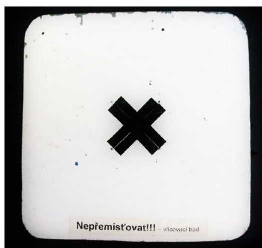
Obr. 12 Vlíčovací bod použitý pro leteckou fotogrammetrii (Mikita et al., 2016)
