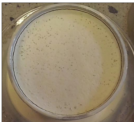
Obr. č. 6 Vzorek s poměrem 20% PR 0,5 - 1 a 80% prachu
