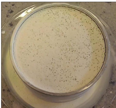
Obr. č. 7 Vzorek s poměrem 40% PR 0,5 - 1 a 60% prachu
