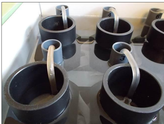
Obr. č. 15 Správné umístění násosky do držáků
