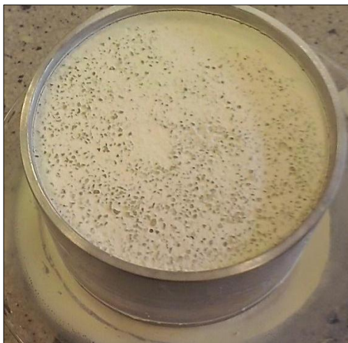
Obr. č. 8 Vzorek s poměrem 60% PR 0,5 - 1 a 40% prachu
