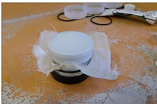
Obr. č. 12 Půdní vzorek s hydrofilní gázou, gumičku a sítkem
