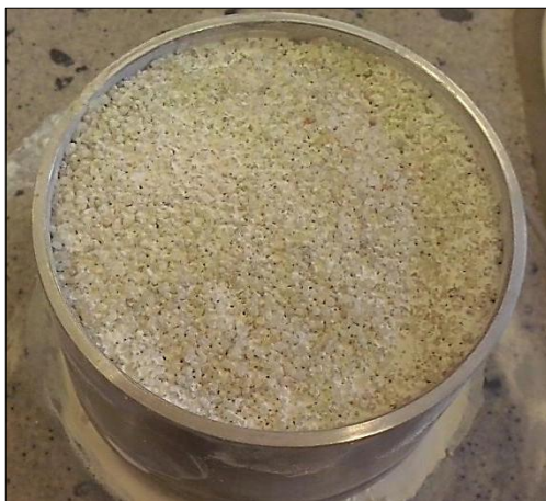
Obr. č. 9 Vzorek s poměrem 80% PR 0,5 - 1 a 20% prachu
