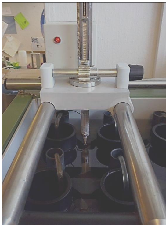
Obr. č. 17 Rozsvícení světelné signalizace po dosažení úrovně hladiny
