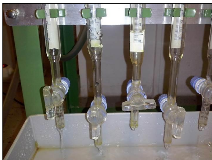
Obr. č. 16 Měření vzorku číslo 3 (zleva) – kohout je uzavřen a byreta se plní vodou
