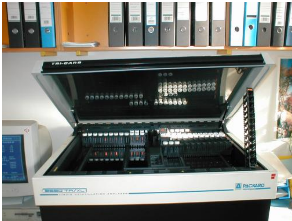
Příloha č. 2: Foto TriCarb otevřený prostor pro vzorky
