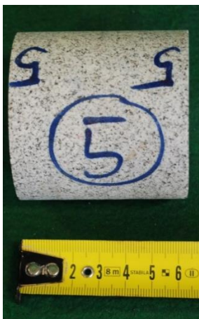
Obr. 8-28 (vlevo) Žula (Mrákotín) 5A, zk. těleso určené pro zkoušku pevnosti v tlaku Obr. 8-29 (vpravo) Žula (Mrákotín) 5B, zk. těleso určené pro stanovení MP
