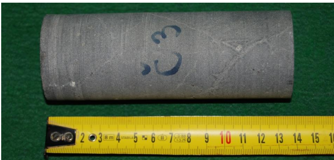
Obr. 8-7 Čedič Č3, zk. těleso určené pro stanovení MP
