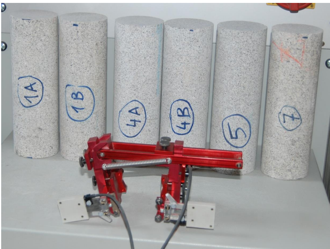
Obr. 8-43 Ilustrativní fotografie sady zkušebních těles ze žuly (z Mrákotína) připravených ke statické zkoušce
