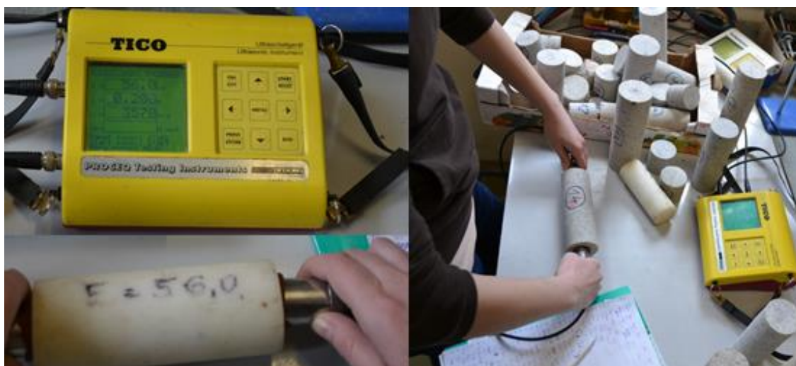
Obr. 4-3 Stanovení dynamického modulu pružnosti ultrazukovou zkouškou.
