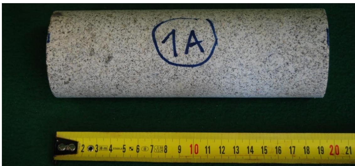
Obr. 8-20 Žula (Mrákotín) 1A, zk. těleso určené pro stanovení MP
