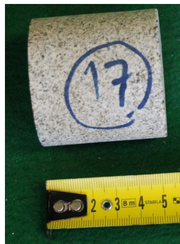
Obr. 8-37 (vlevo) Žula (Mrákotín) 14A, zk. těleso určené pro zkoušku pevnosti v tlaku
