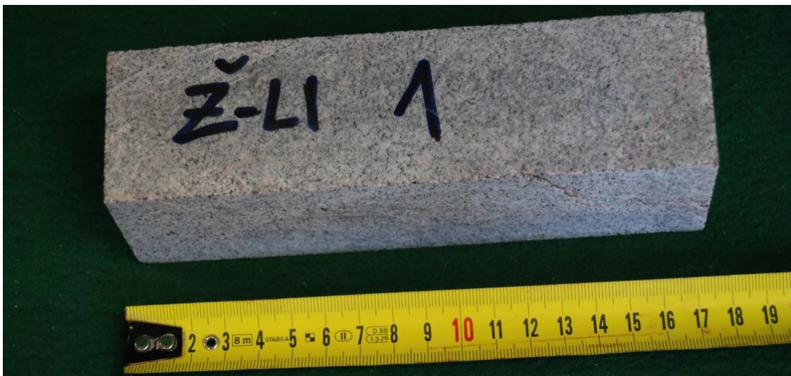
Obr. 8-17 Žula (Litice) Ž-L11, zk. těleso určené pro stanovení MP
