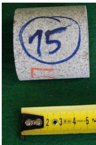
Obr. 8-37 (vlevo) Žula (Mrákotín) 14A, zk. těleso určené pro zkoušku pevnosti v tlaku
