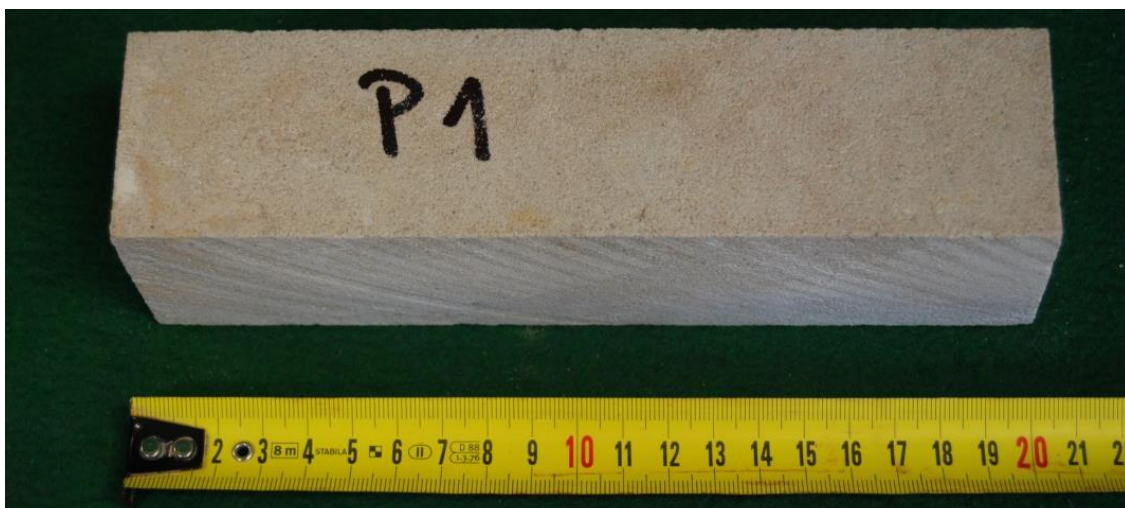
Obr. 8-11 Pískovec P1, zk. těleso určené pro stanovení MP
