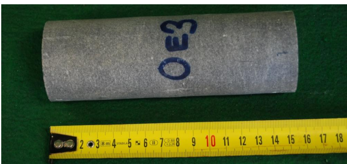
Obr. 8-10 K. vápenec OE3, zk. těleso určené pro stanovení MP
