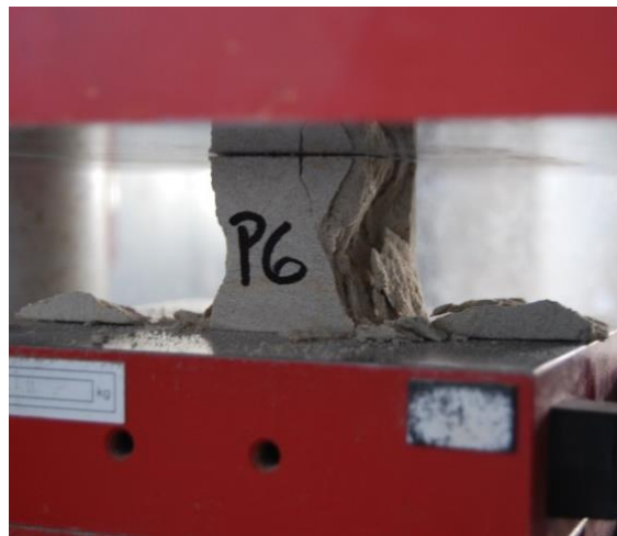
Obr. 4-5 Zkušební těleso P6 po pevnostní zkoušce.
