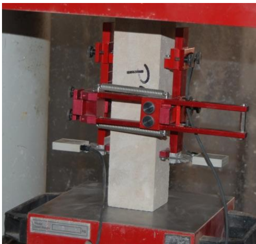
Obr. 4-4 Zkušební těleso uložené v lisu s osazenými měřicími přístroji.
