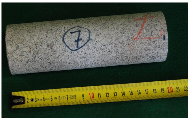
Obr. 8-30 (vlevo) Žula (Mrákotín) 7A, zk. těleso určené pro zkoušku pevnosti v tlaku Obr. 8-31 (vpravo) Žula (Mrákotín) 7B, zk. těleso určené pro stanovení MP
