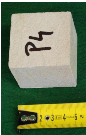
Obr. 8-14 (vlevo) Pískovec P4, zk. těleso určené pro zkoušku pevnosti v tlaku
