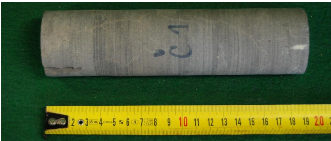
Obr. 8-5 Čedič Č1, zk. těleso určené pro stanovení MP (zjevné vady tělesa, která však pravděpodobně neměly vliv na výsledek MP)
