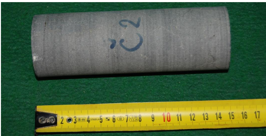
Obr. 8-6 Čedič Č2, zk. těleso určené pro stanovení MP
