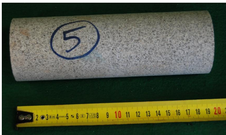
Obr. 8-28 (vlevo) Žula (Mrákotín) 5A, zk. těleso určené pro zkoušku pevnosti v tlaku Obr. 8-29 (vpravo) Žula (Mrákotín) 5B, zk. těleso určené pro stanovení MP
