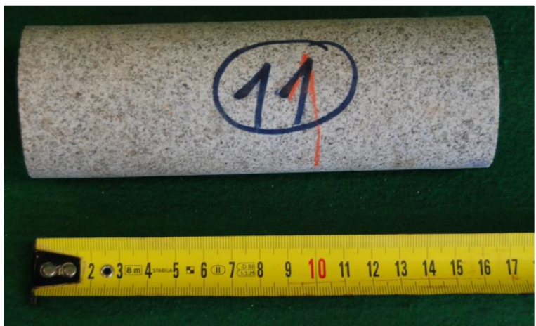
Obr. 8-32 (vlevo) Žula (Mrákotín) 11A, zk. těleso určené pro zkoušku pevnosti v tlaku Obr. 8-33 (vpravo) Žula (Mrákotín) 11B, zk. těleso určené pro stanovení MP
