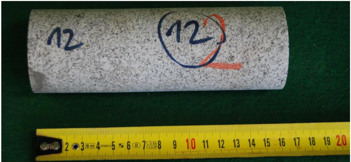
Obr. 8-34 Žula (Mrákotín) 12, zk. těleso určené pro stanovení MP
