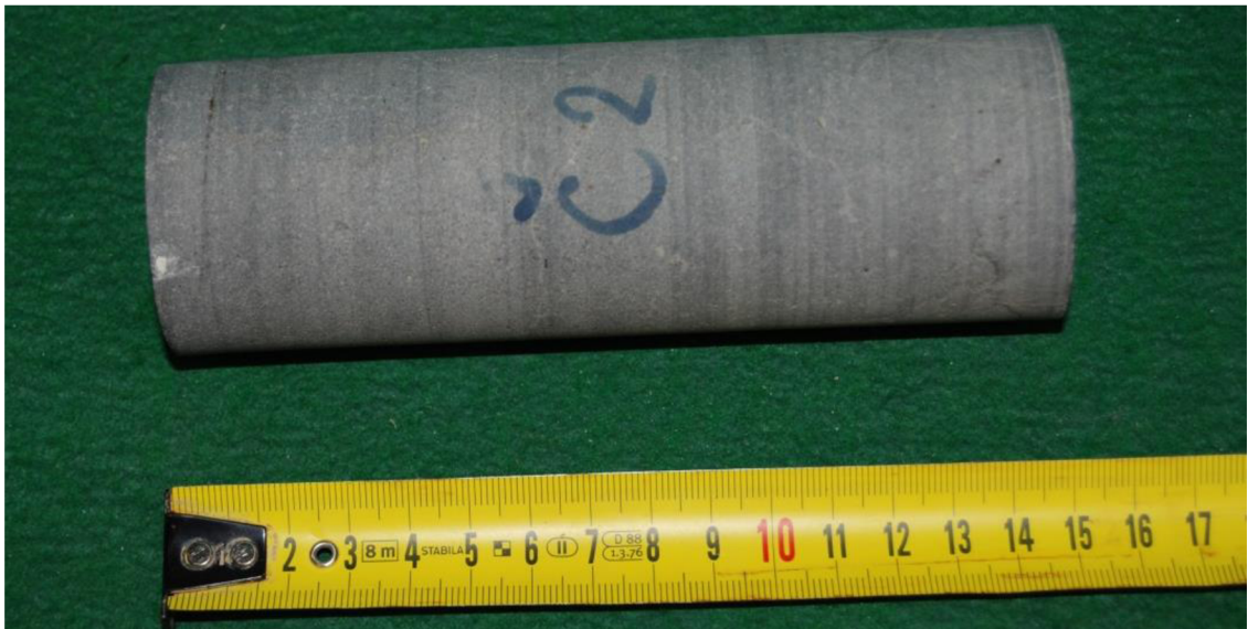
Obr. 8-6 Čedič Č2, zk. těleso určené pro stanovení MP
