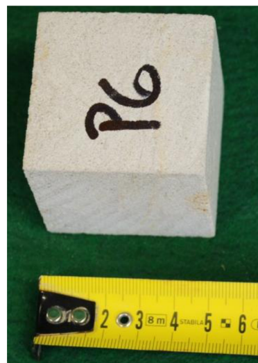
Obr. 8-14 (vlevo) Pískovec P4, zk. těleso určené pro zkoušku pevnosti v tlaku
