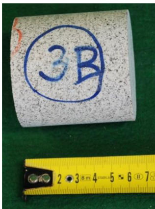
Obr. 8-25 (vlevo) Žula (Mrákotín) 3B, zk. těleso určené pro zkoušku pevnosti v tlaku
