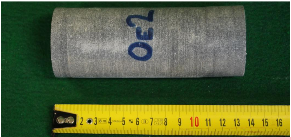
Obr. 8-9 K. vápenec OE2, zk. těleso určené pro stanovení MP
