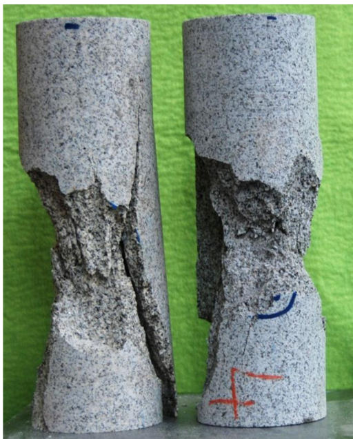
Obr. 4-9 Více (vlevo) a méně (vpravo) zvětralé vzorky žuly z Mrákotína.
