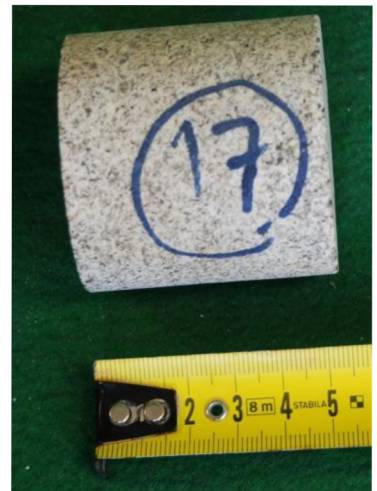
Obr. 8-37 (vlevo) Žula (Mrákotín) 14A, zk. těleso určené pro zkoušku pevnosti v tlaku
