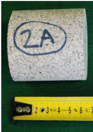
Obr. 8-22 (vlevo) Žula (Mrákotín) 2A, zk. těleso určené pro zkoušku pevnosti v tlaku
