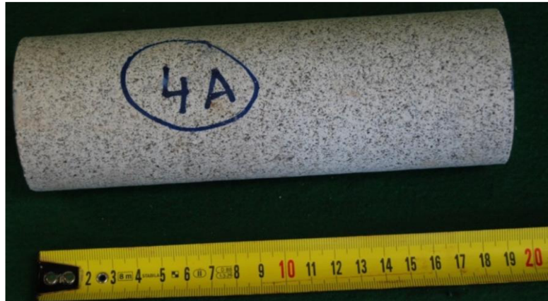
Obr. 8-25 (vlevo) Žula (Mrákotín) 3B, zk. těleso určené pro zkoušku pevnosti v tlaku
