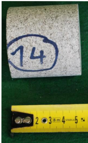
Obr. 8-37 (vlevo) Žula (Mrákotín) 14A, zk. těleso určené pro zkoušku pevnosti v tlaku
