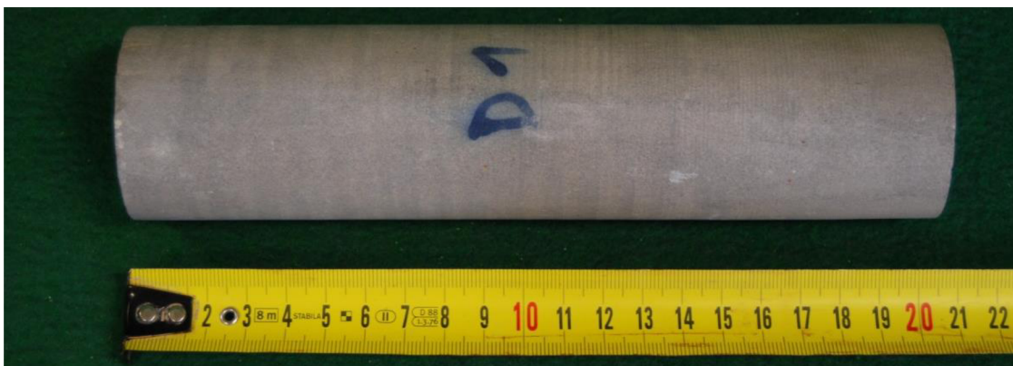
Obr. 8-1 Droba D1, zk. těleso určené pro stanovení MP
