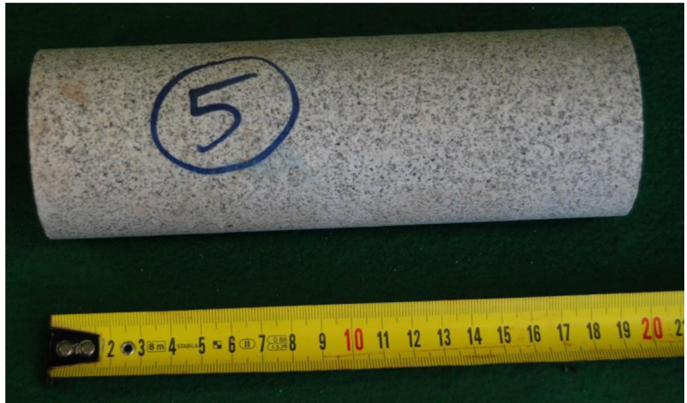
Obr. 8-28 (vlevo) Žula (Mrákotín) 5A, zk. těleso určené pro zkoušku pevnosti v tlaku Obr. 8-29 (vpravo) Žula (Mrákotín) 5B, zk. těleso určené pro stanovení MP
