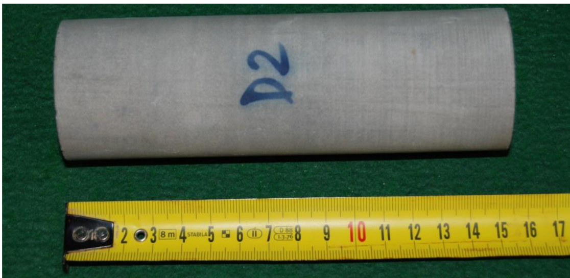
Obr. 8-2 Droba D2, zk. těleso určené pro stanovení MP
