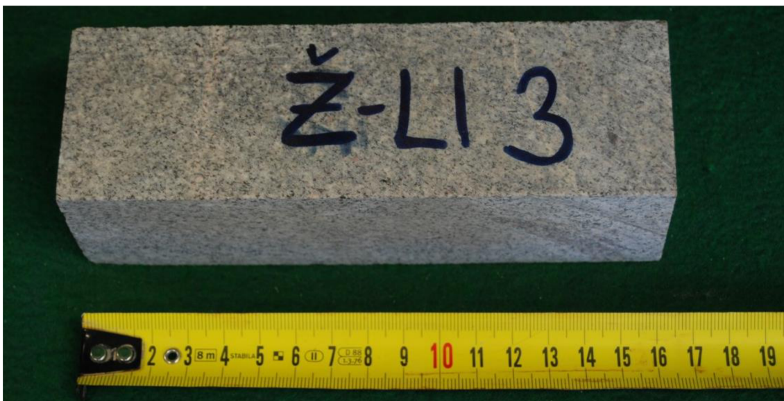
Obr. 8-19 Žula (Litice) Ž-L13, zk. těleso určené pro stanovení MP
