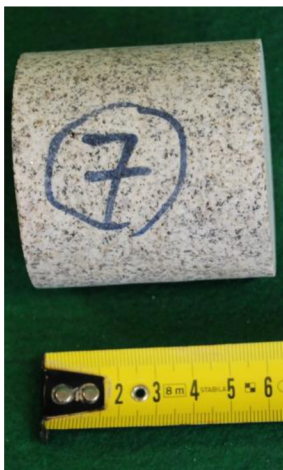
Obr. 8-30 (vlevo) Žula (Mrákotín) 7A, zk. těleso určené pro zkoušku pevnosti v tlaku Obr. 8-31 (vpravo) Žula (Mrákotín) 7B, zk. těleso určené pro stanovení MP
