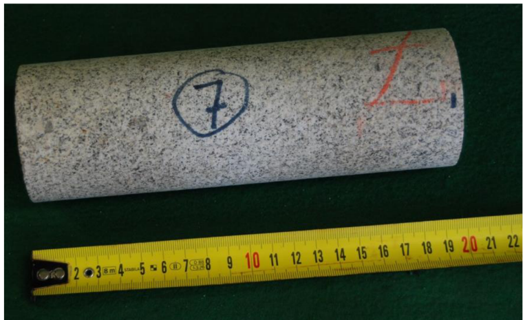
Obr. 8-30 (vlevo) Žula (Mrákotín) 7A, zk. těleso určené pro zkoušku pevnosti v tlaku Obr. 8-31 (vpravo) Žula (Mrákotín) 7B, zk. těleso určené pro stanovení MP
