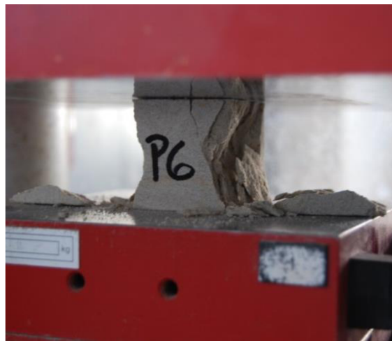
Obr. 4-5 Zkušební těleso P6 po pevnostní zkoušce.
