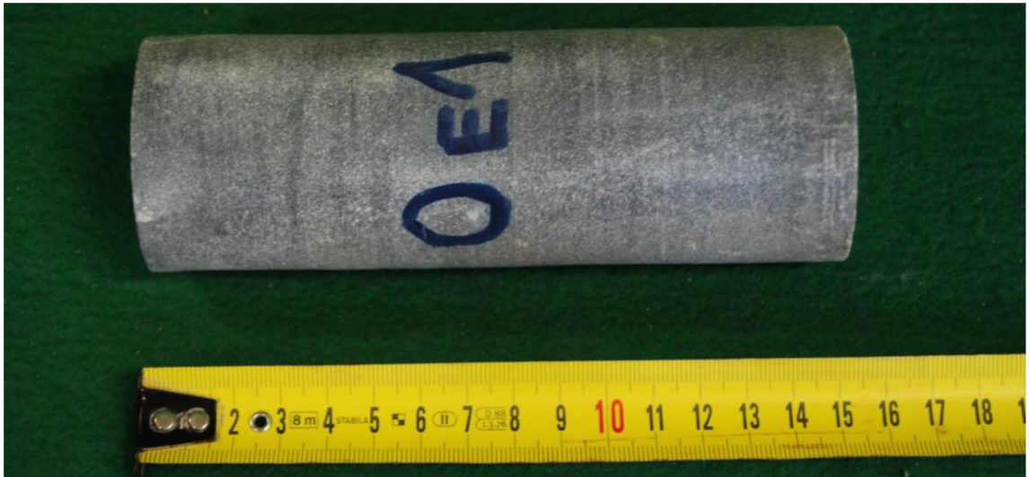
Obr. 8-8 K. vápenec OE1, zk. těleso určené pro stanovení MP
