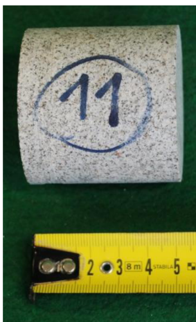
Obr. 8-32 (vlevo) Žula (Mrákotín) 11A, zk. těleso určené pro zkoušku pevnosti v tlaku Obr. 8-33 (vpravo) Žula (Mrákotín) 11B, zk. těleso určené pro stanovení MP
