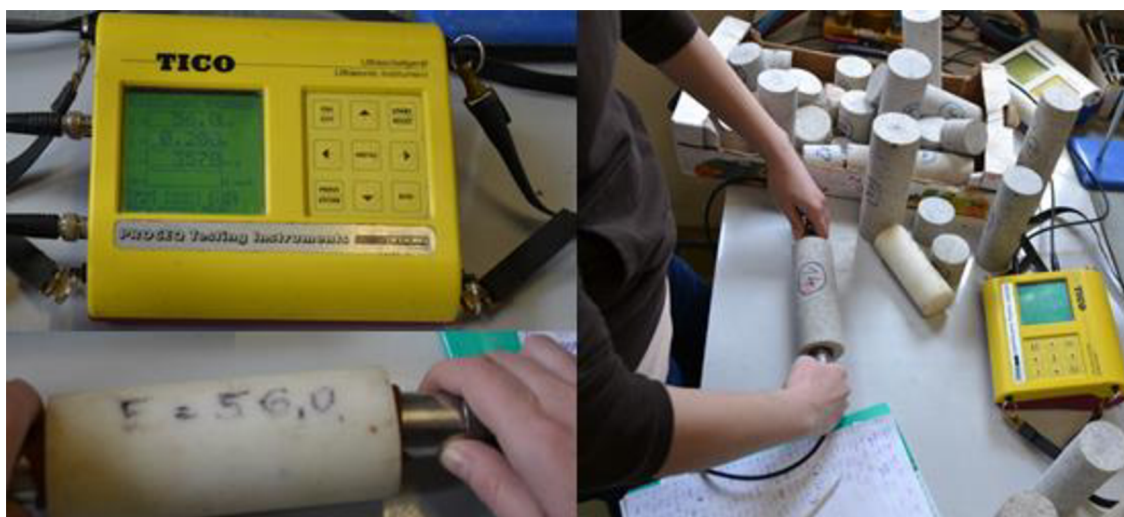
Obr. 4-3 Stanovení dynamického modulu pružnosti ultrazvukovou zkouškou.
