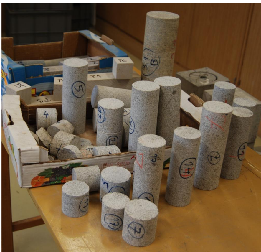
Obr. 4-1 Zkušební tělesa připravená pro experiment.
