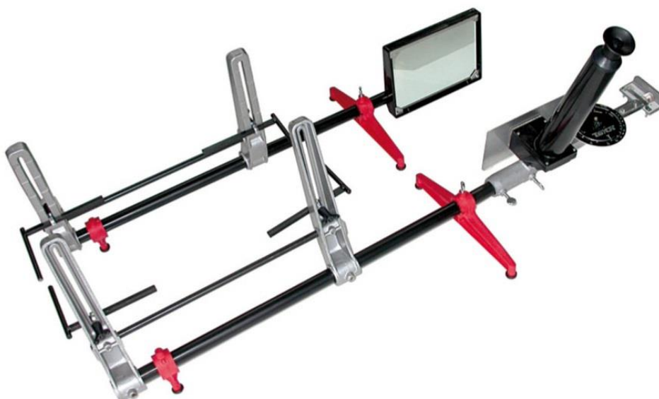
Obr. 23 Optické zřízení s nepřímou projekcí pro měření sbíhavosti [17]
