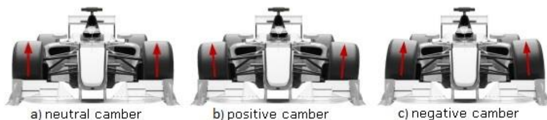
Obr. 1 Odklon kola [20]; a) nulový, b) kladný, c) záporný
