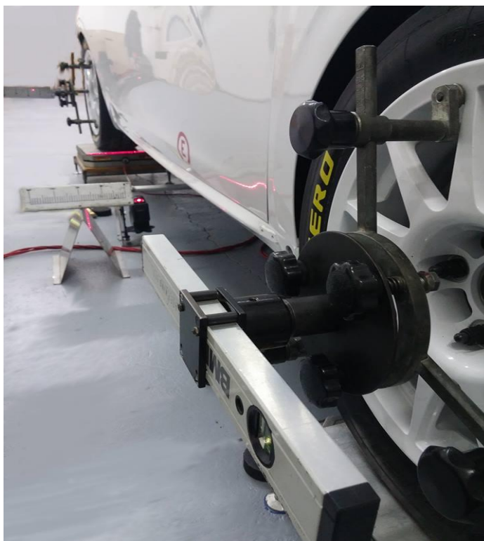
Obr. 22 Optické měření přímou projekcí
