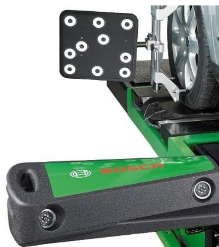
Obr. 24 Princip měření geometrie přístrojem BOSCH FWA 4630 [13]
