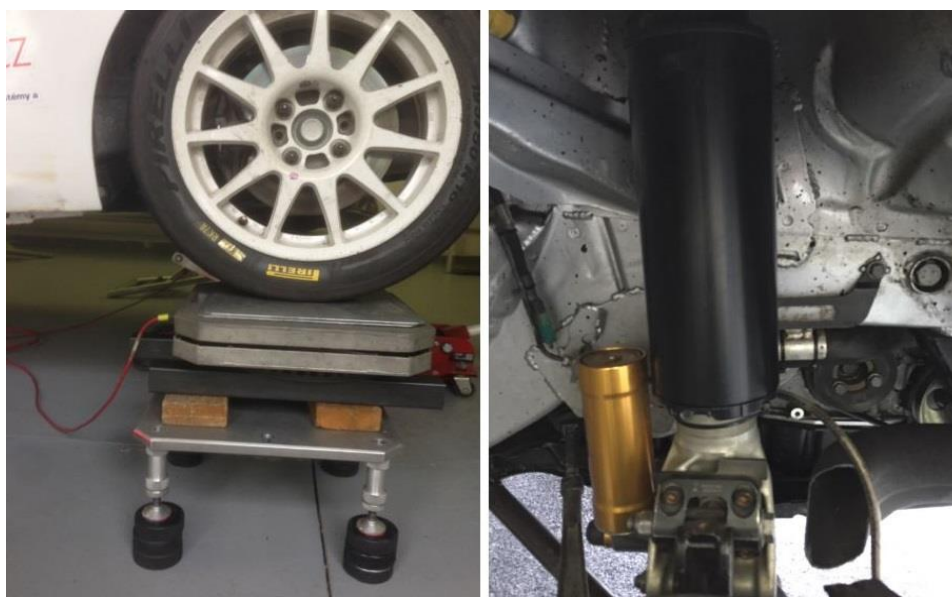
Obr. 29 Měření výškové polohy těžiště vozidla
