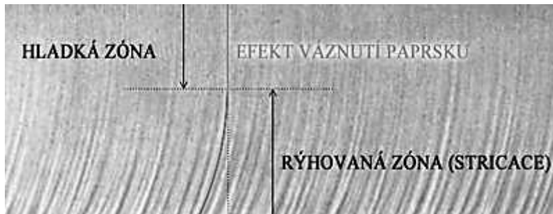
Obr. 5.1 Oblasti kvality znázorněné na fotografii řezu vodním paprskem
