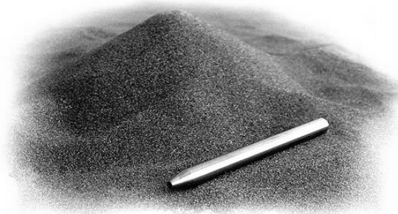
Obr. 4.8 Ostřívo pro vodní paprsek MESH80 a abrazivní tryska
