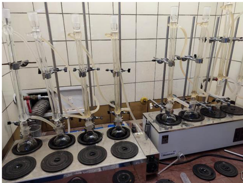
Obrázek 13: Extrakce pod zpětným chladičem (Liebigův chladič)
