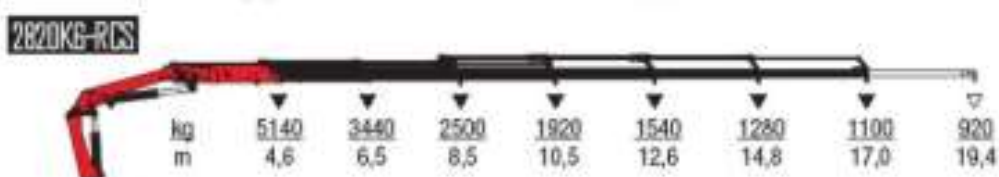
Obr. č. 51 Dosah hydraulické ruky (27)
