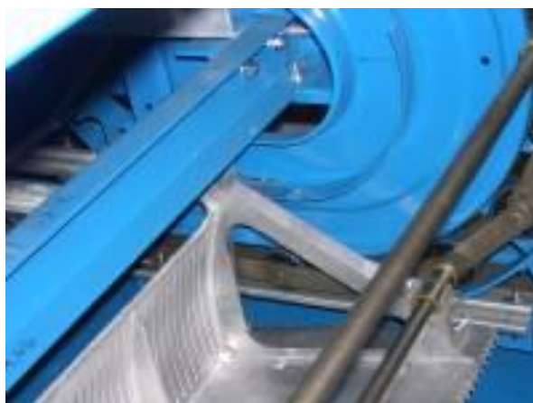
Obrázek 10 Řetěz v poloze pro vložení další schodnice [11]
