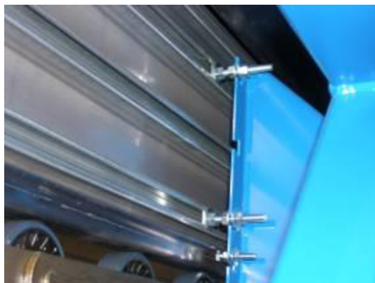
Obrázek 14 Nastavení pozice okopového panelu [11]
