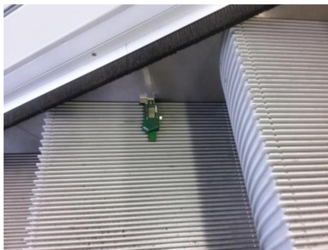
Obrázek 19 Měření na nášlapné ploše schodnice [13]
