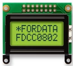
Obrázek 2.12: LCD displej Fordata 8×2 znaků
