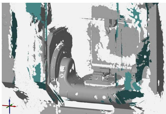
Obr. 33. Nasnímaný vnitřek stroje přístrojem MetraSCAN od CREAFORM
