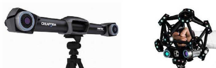
Obr. 32. Tracker systém Creafom. vlevo: Tracker systém = stativ se dvěma kamerami, vpravo: vlastní ruční skener MetraSCAN.[28]
