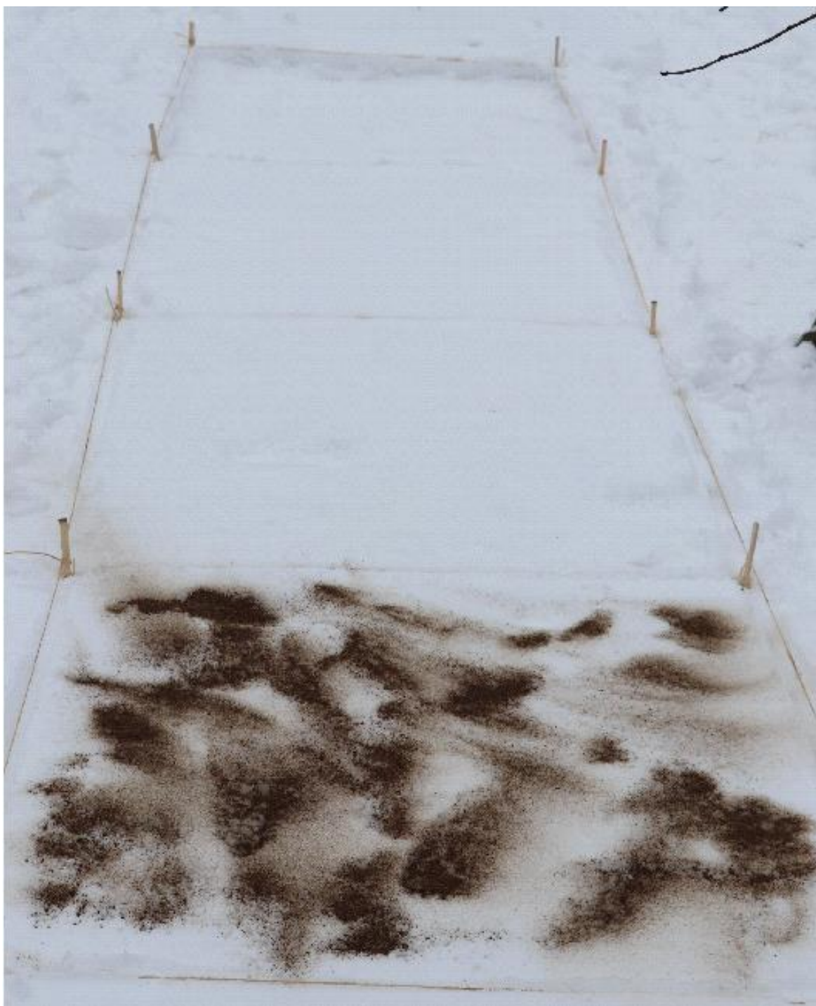
Obr. 37: Fotografie experimentu tání sněhu č. 1. V nejbližším tmavém čtverci je silniční posyp se solenkou, vedle něho ve druhém čtverci sníh posypaný kuchyňskou solí, ve třetím čtverci neponičený sníh a v nejvzdálenějším čtverci sníh udupaný váhou 60 kg.
