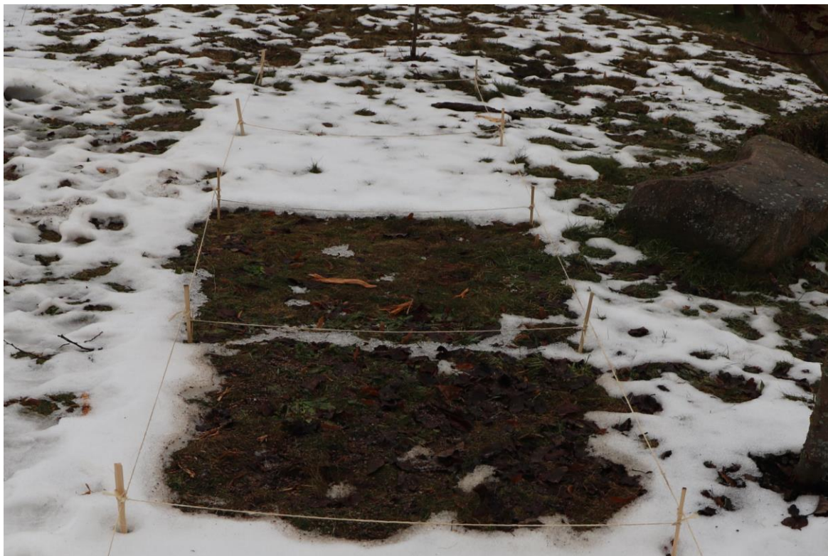
Obr. 44: Záznam experimentu tání sněhu č. 5, kde nejbližší čtverec představuje sníh s posypem a solenkou, druhý s kuchyňskou solí, třetí bez zásahu a čtvrtý s udusným sněhem.
