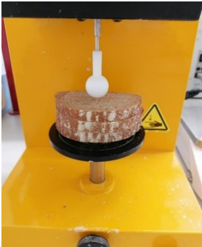
Obrázek 8: Průběh měření pevnosti střídy vertikálním vpichem sondy do střídy výrobku.
