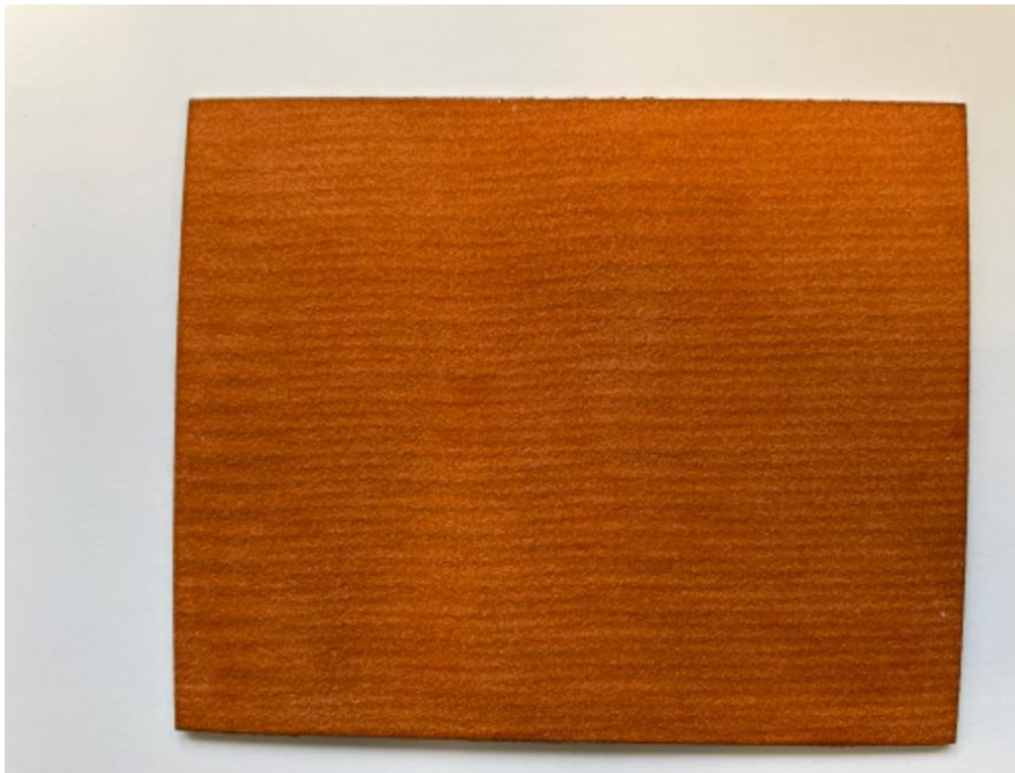
Obrázek 3.4 Vrstva Cu na Al substrátu vytvořená pomocí Cold spray
