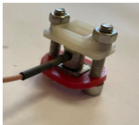
Obrázek 3.15 Kondenzační komora – vzorek E168h po 168 hodin zkoušky
