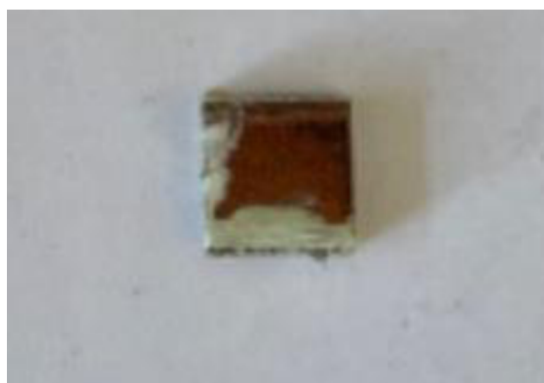
Obrázek 3.22 Kondenzační komora – vzorek E552h - nátěr po 552 hodinách zkoušky
