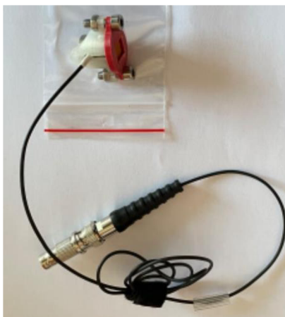
Obrázek 3.23 Klec na vzorek pro čidlo akustické emise
