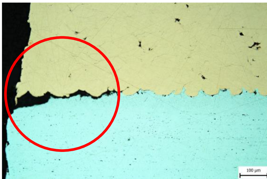
Obrázek 3.39 MG Vzorek E168h – nátěr, hrana bez antikoroziního nátěru – detail rozvrstvení
