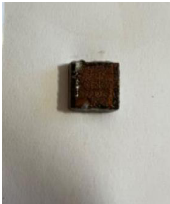
Obrázek 3.21 Kondenzační komora – vzorek E576h po 576 hodinách zkoušky
