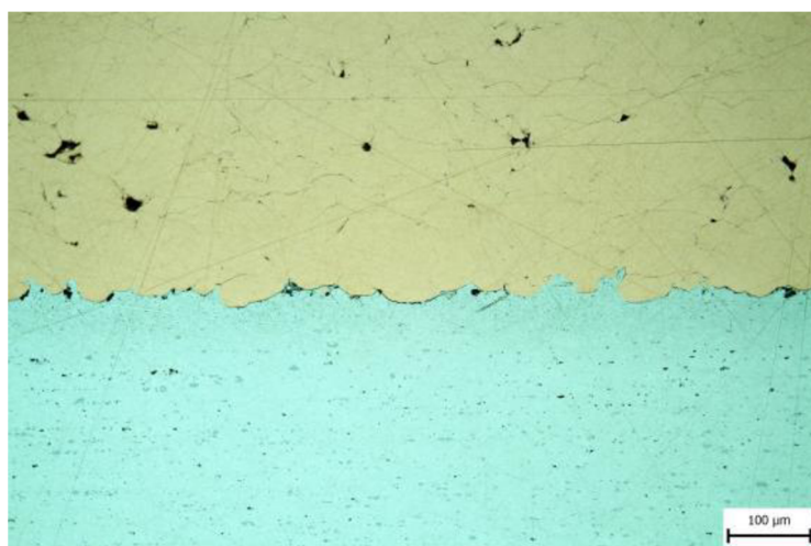
Obrázek 3.40 MG Vzorek E168h – nátěr, hrana s antikoroziním nátěrem – detail oxidických obálek na rozhraní Al - Cu
