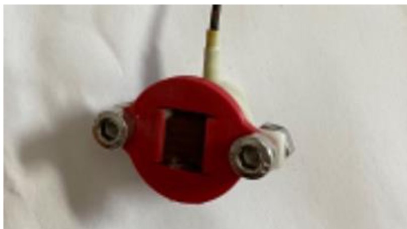
Obrázek 3.20 Kondenzační komora – vzorek E576h po 576 hodinách zkoušky
