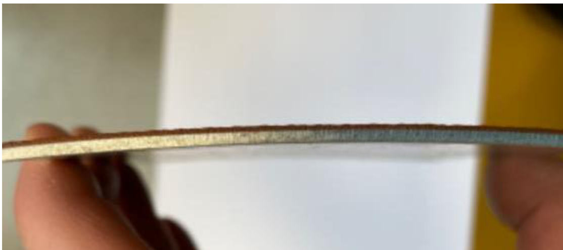
Obrázek 3.5 Vrstva Cu na Al substrátu vytvořená pomocí Cold spray
