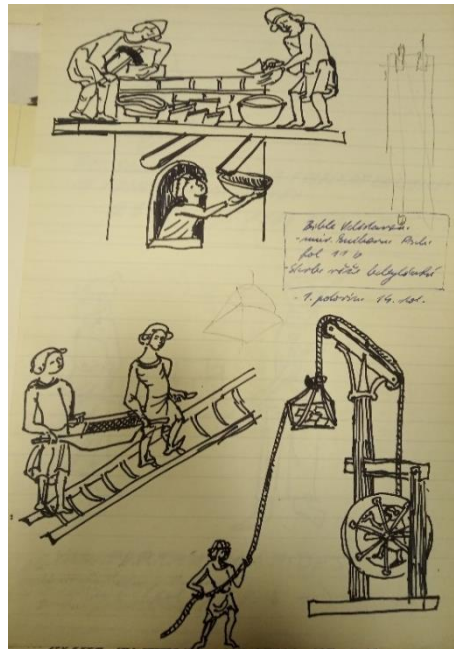
Obr. 5 Příklady raně středověkých stavebních technik. Aleš Rozehnal, Staré stavební techniky, 1973–1979, perokresba, Pozůstalost AR, archiv MUO, složka č. 75.
