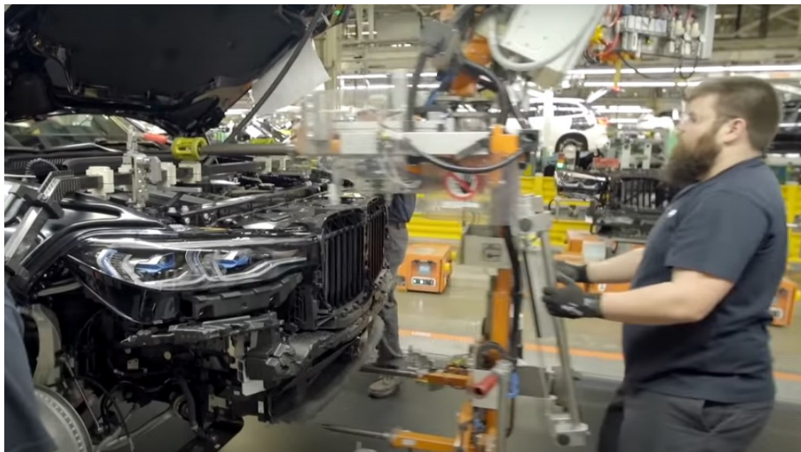
Obr. 4.6: Ruční montáž frontendu u společnosti BMW v USA.
