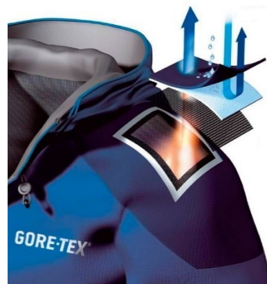
Obrázek 5 Dvouvrstvá laminace s volnou podšívkou [4]
