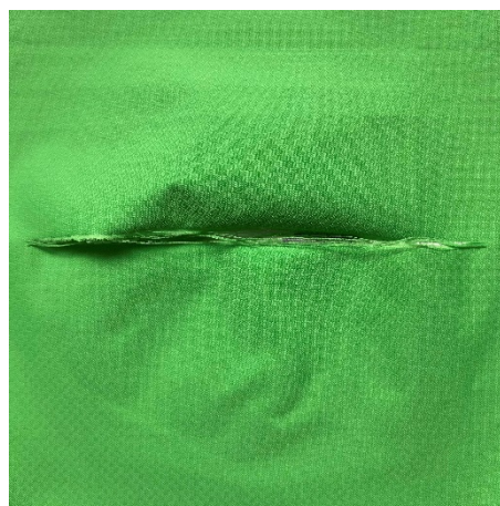
Obrázek 54 Ukázka přetruhu lícní textilie u dvouvrstvého materiálu (10. vzorek)
