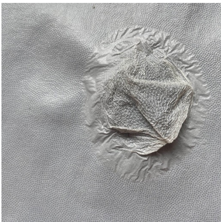
Obrázek 52 Ukázka odlepení laminačních bodů u dvouvrstvého materiálu (11. vzorek)
