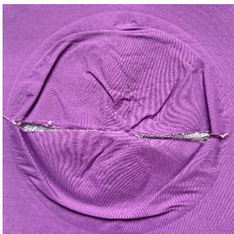
Obrázek 55 Ukázka přetruhu lícní textilie u třívrstvého materiálu (1. vzorek)
