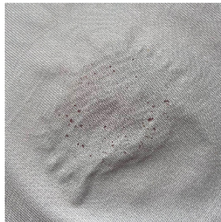
Obrázek 53 Ukázka odlepení laminačních bodů u třívrstvého materiálu (8. vzorek)
