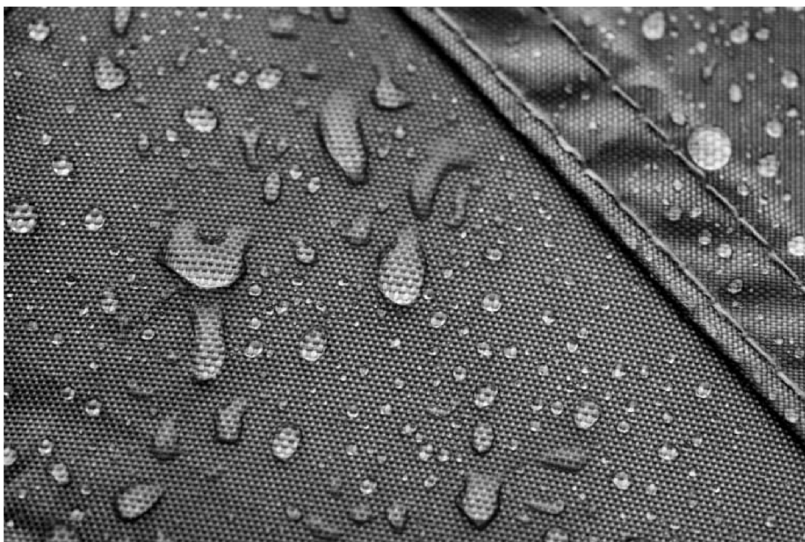
Obrázek 10 Ukázka DWR úpravy [8]
