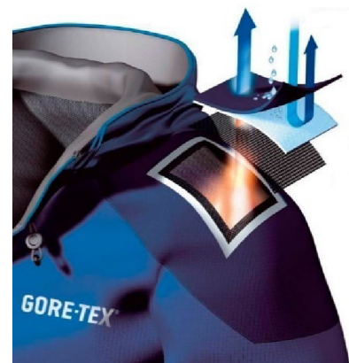
Obrázek 5 Dvouvrstvá laminace s volnou podšívkou [4]
