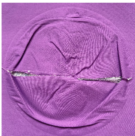
Obrázek 55 Ukázka přetrhu lícní textilie u třívrstvého materiálu (1. vzorek)
