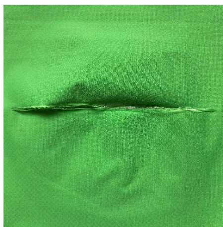
Obrázek 54 Ukázka přetrhu lícní textilie u dvouvrstvého materiálu (10. vzorek)
