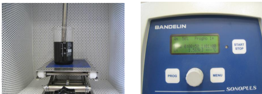
Obr. 31. Míchání v ultrazvukového homogenizátoru + nastavení
