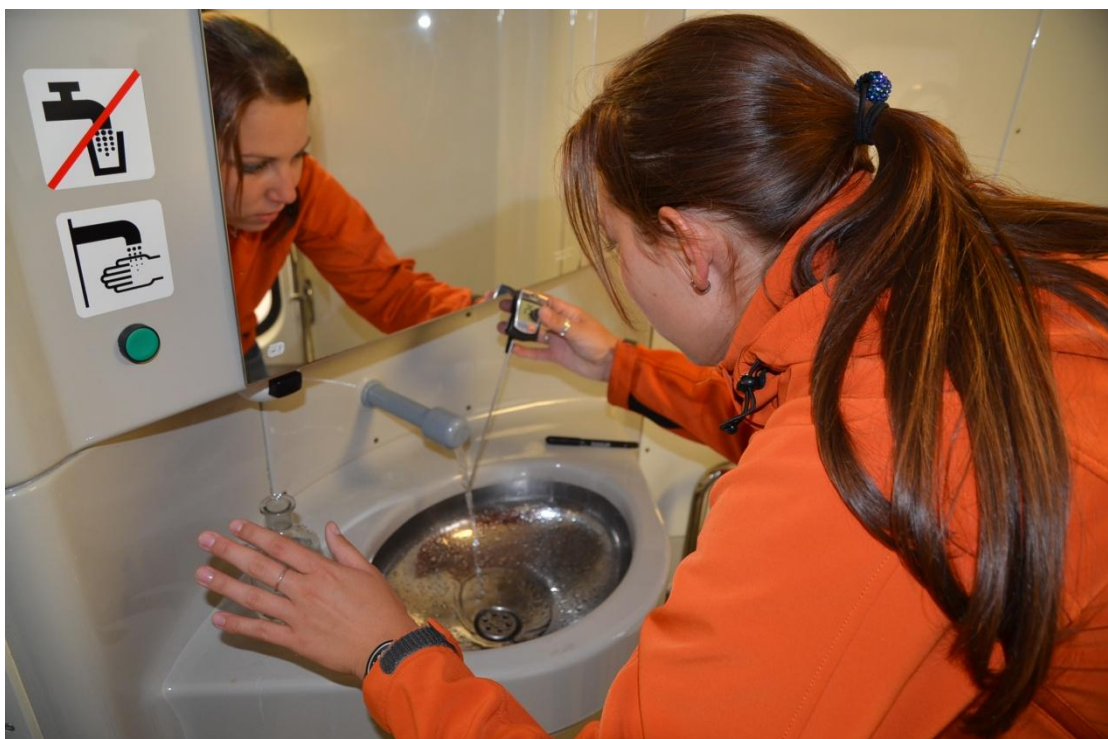
Obr. 5 Měření teploty vody na toaletě ve vlaku (foto: A. Škrobalová)
