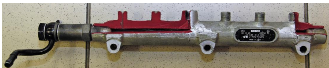
Obr. 5: Tlakový zásobník motorové nafty
