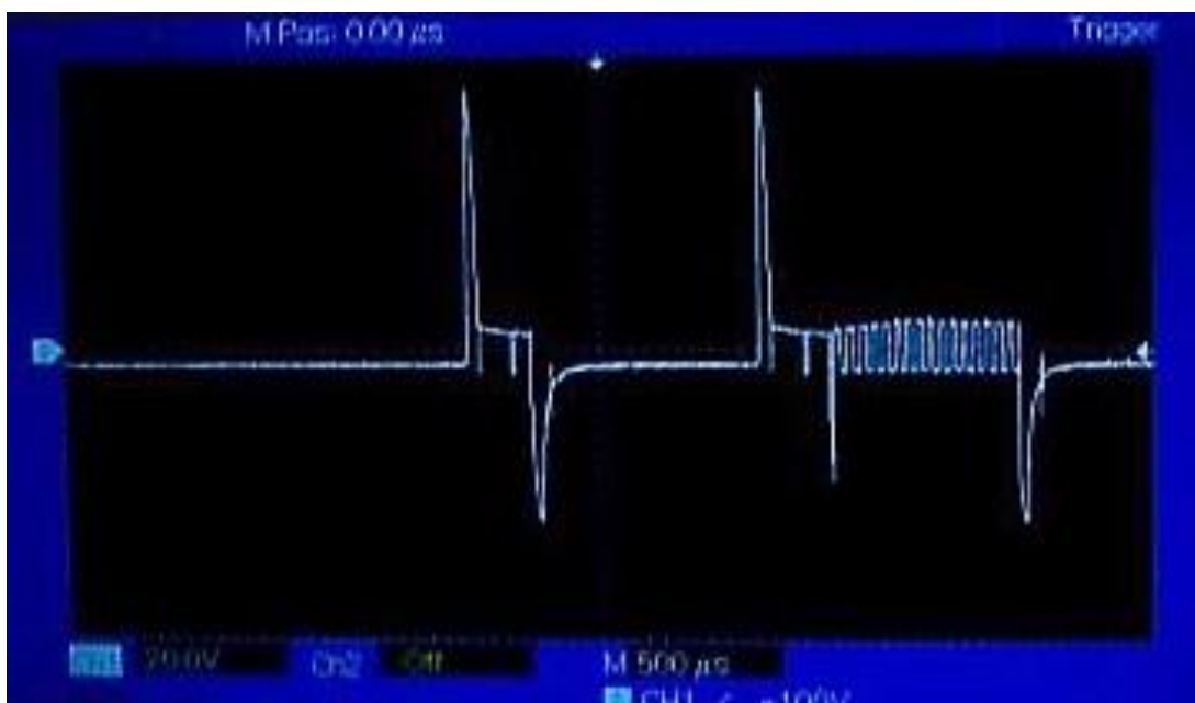
Obr. 42: Zobrazený signál měřený na vstřikovači 1. válce výukového panelu
