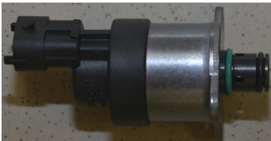
Obr. 9: Dávkovací ventil paliva
