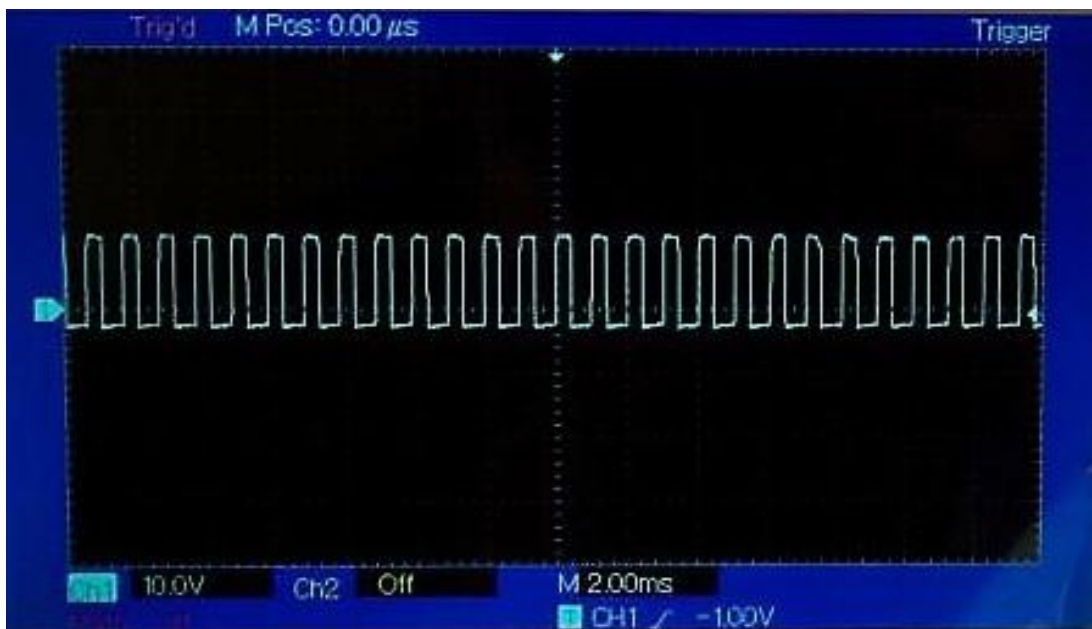
Obr. 41: Zobrazený signál měřený na dávkovacím ventilu výukového panelu
