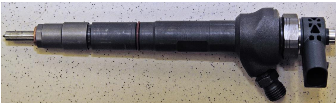
Obr. 8: Elektromagneticky ovládaný vstřikovač motorové nafty
