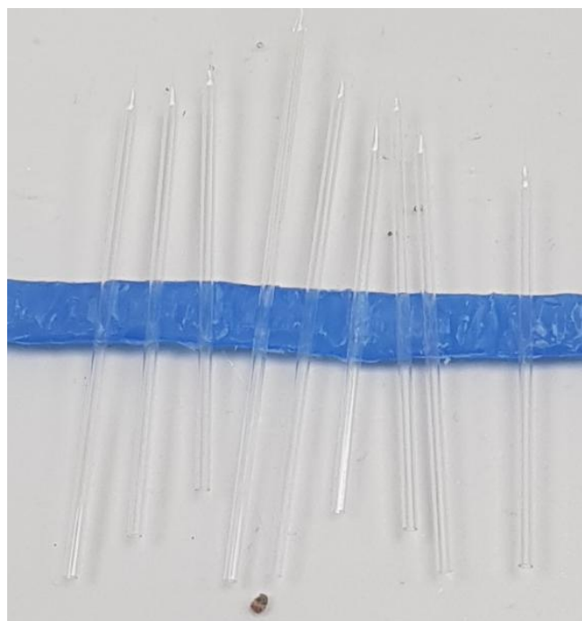
Příloha 5: Skleněné elektrody, sloužící k zapojení tykadla, vyrobené pomocí vertikálního tahače PC-100.
