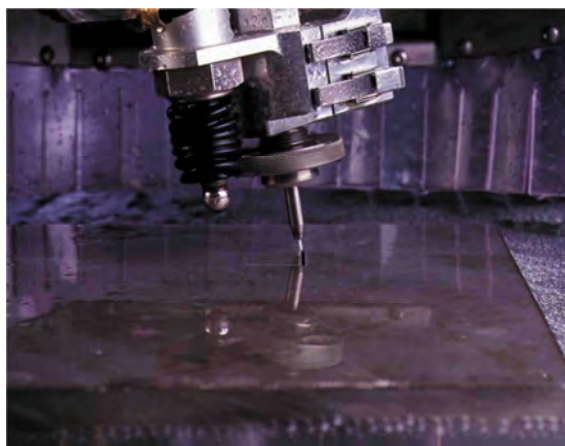
Obr. 2.2 Řezací hlavice Dynamic Waterjet [30].
