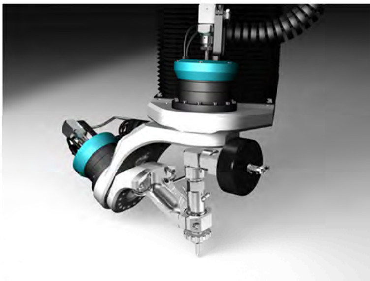
Obr. 2.5 Řezací hlavice Dynamic Waterjet XD [30].
