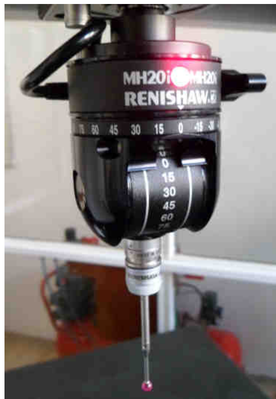
Obr. 3.6 Měřicí sonda MH20i s nástavcem a sondou.
