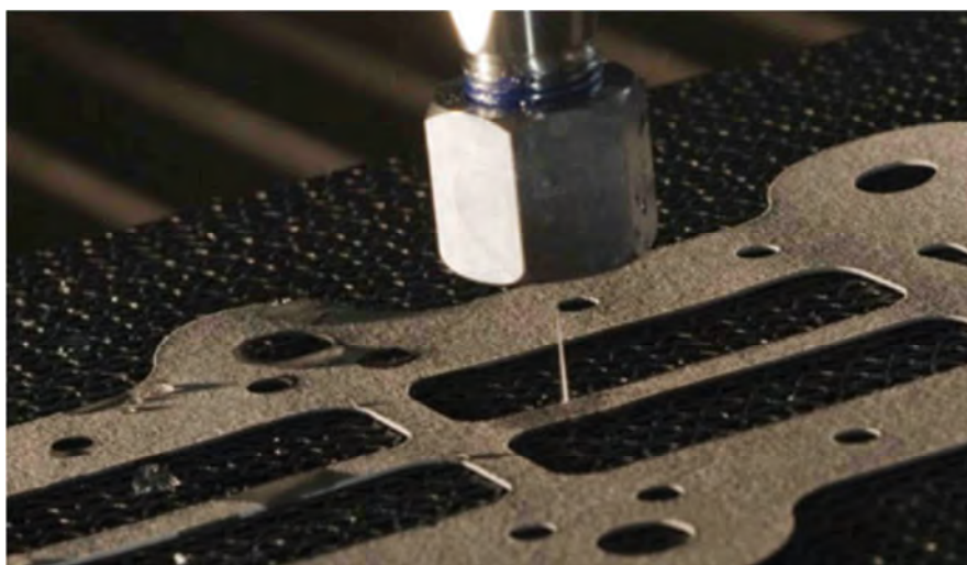
Obr. 2.17 Čistý vodní paprsek, jako příslušenství k 3D systému firmy FLOW [51].
