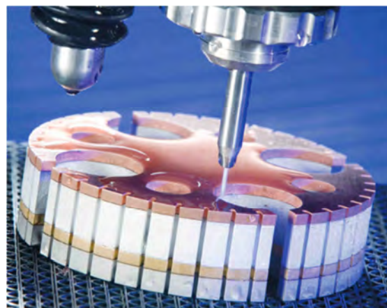
Obr. 2.3 Řezání vrstvených materiálů technologií Dynamic Waterjet [30].
