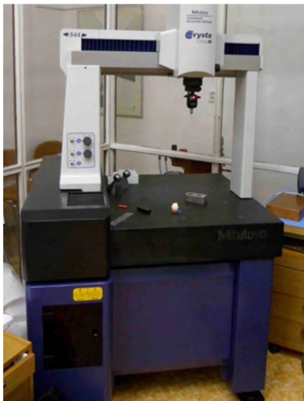
Obr. 3.5 Měřicí zařízení CRYSTA-PLUS M544 na ústavu výrobních strojů, systémů a robotiky.
