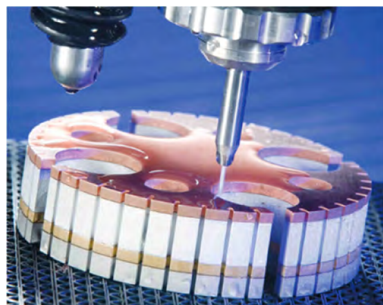
Obr. 2.3 Řezání vrstvených materiálů technologií Dynamic Waterjet [30].
