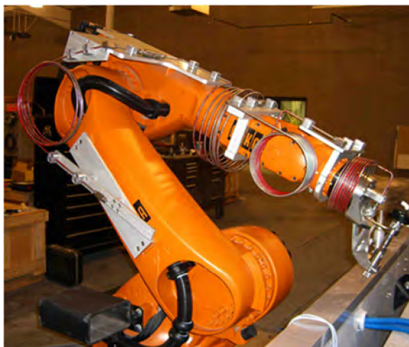
Obr. 2.7 Průmyslový robot firmy KUKA se systémem vodního paprsku od firmy FLOW [39].
