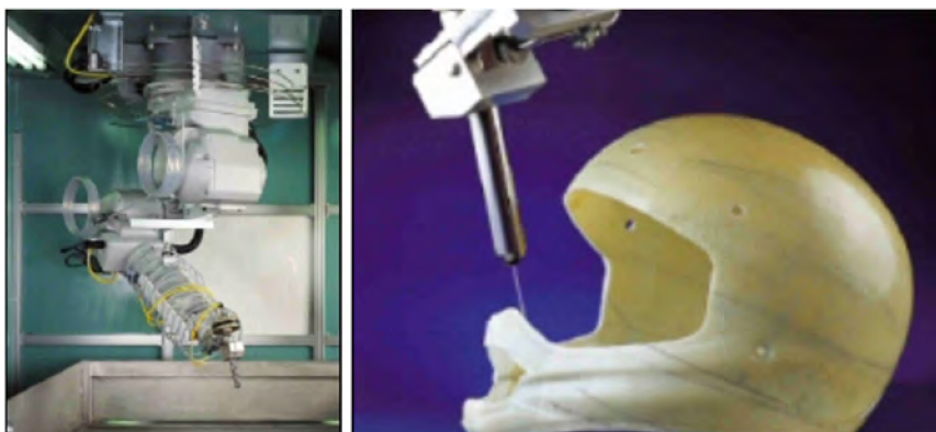
Obr. 2.8 Výroba součásti s použitím robotického ramene [40].
