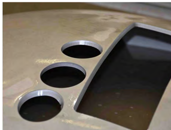
Obr. 2.15 Víko tlakové vodní nádrže vyrobeno za pomoci 3D řezací hlavy s regulátorem výšky[48].
