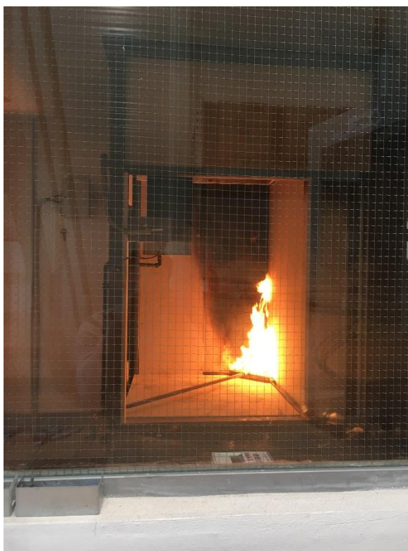
Obrázek 18 Ukázka požárně odolného skla při zkoušce SBI.
