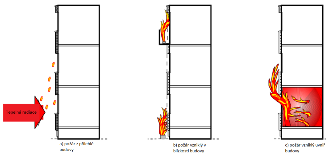
Obrázek 9 Tři základní scénáře požáru fasád [16].
