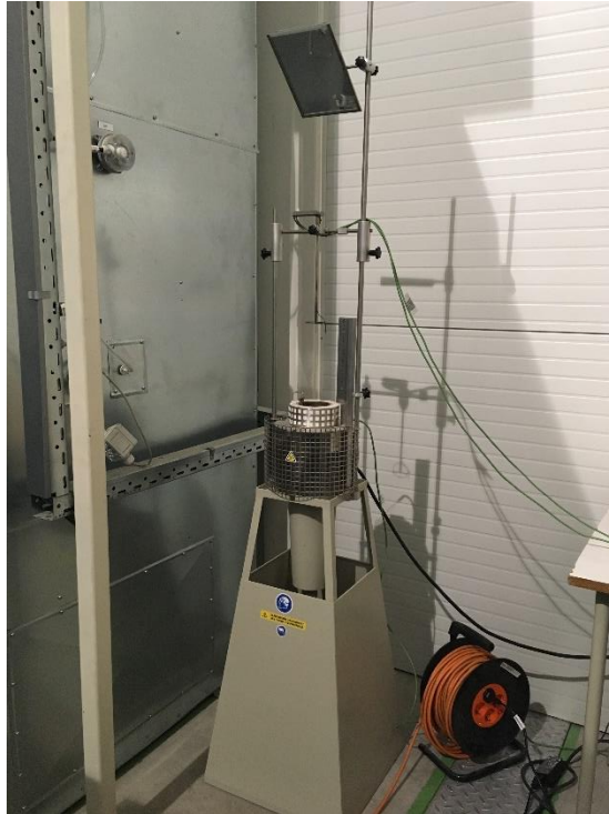
Obrázek 21 Zkušební pec pro zkoušení nehořlavosti.
