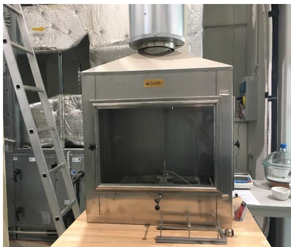
Obrázek 11 Zkušební komora pro zkoušku malého zdroje plamene.
