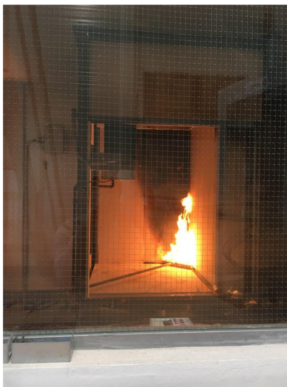
Obrázek 18 Ukázka požárně odolného skla při zkoušce SBI.
