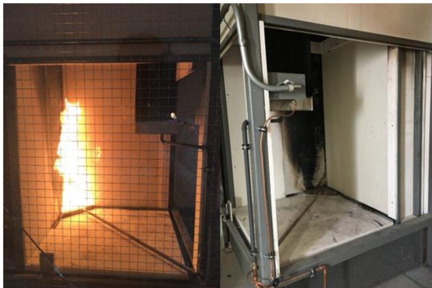
Obrázek 20 Umístění primárního a sekundárního hořáku (vlevo) a zásuvný vozík ve zkušební komoře (vpravo).
