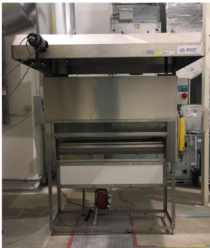
Obrázek 16 Zkušební komora pro stanovení chování při hoření užitím zdroje sálavého tepla.
