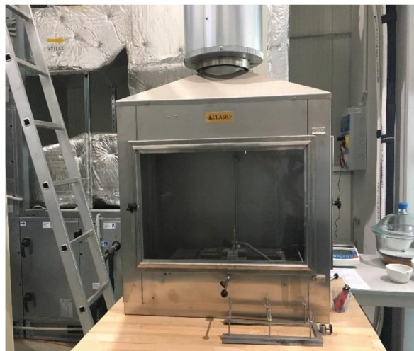
Obrázek 11 Zkušební komora pro zkoušku malého zdroje plamene.
