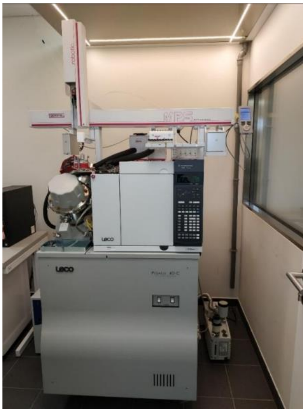
Obrázek 7: Dvojměrný plynový chromatograf Agilent 7890 B s hmotnostním spektrometrickým detektorem TOF Pegasus 4D (Leco Corporation, USA) s automatickým ramenem pro nástřik vzorků (vlastní zdroj)
