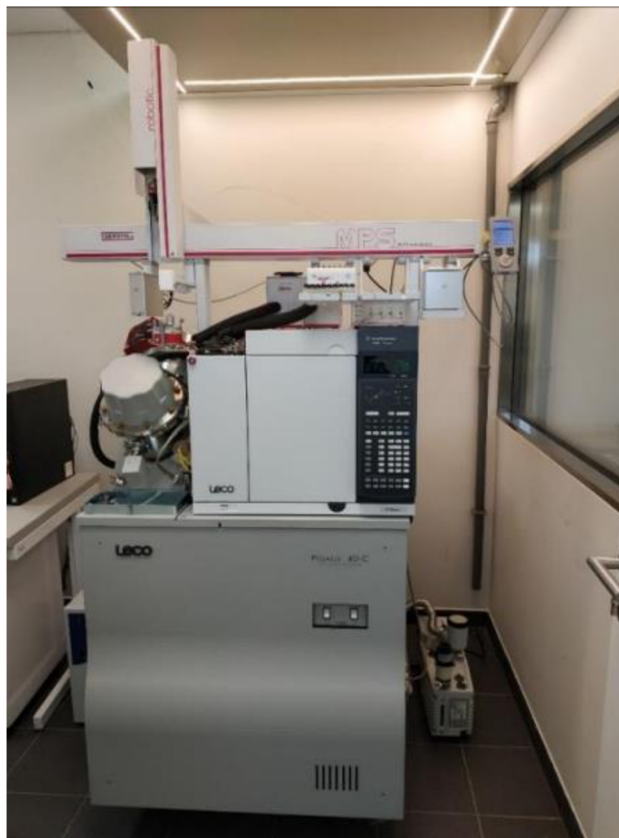
Obrázek 7: Dvojměrný plynový chromatograf Agilent 7890 B s hmotnostním spektrometrickým detektorem TOF Pegasus 4D (Leco Coporation, USA) s automatickým ramenem pro nástřik vzorků (vlastní zdroj)
