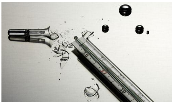
Obr. 16 Rozbitý teploměr s uvolněnou rtuť 50
