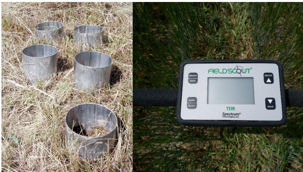
Obrázek 8. Prstence, do kterých byl aplikován daný objem vody (vlevo) a vlhkoměr FIELDSCOUT TDR 350 (vpravo) (foto: Bárta)
