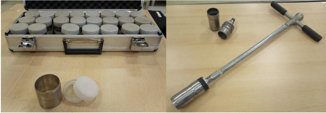
Obrázek 6. Kopeckého válečky k odběru neporušených půdních vzorků (vlevo) s odběrovou hlavicí (vpravo) (foto: Bárta)
