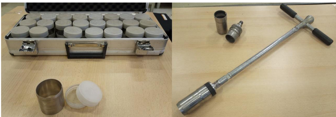
Obrázek 6. Kopeckého válečky k odběru neporušených půdních vzorků (vlevo) s odběrovou hlaví (vpravo) (foto: Bárta)
