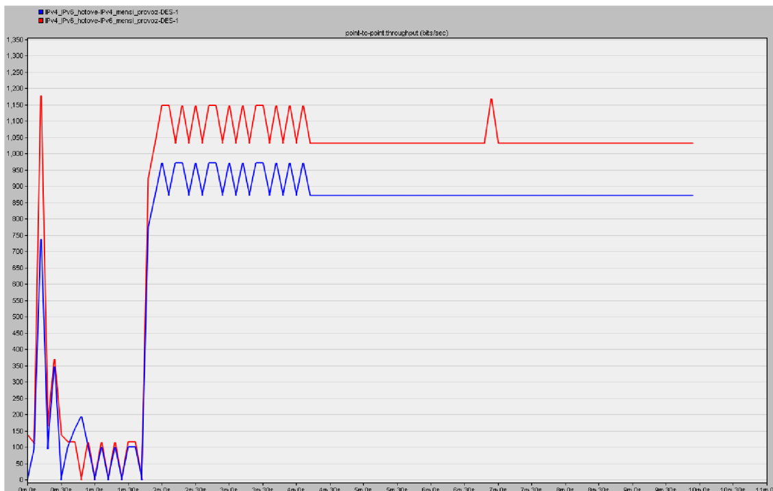
Obr. C.2: Propustnost linek pro scénáře s nižším provozem.
