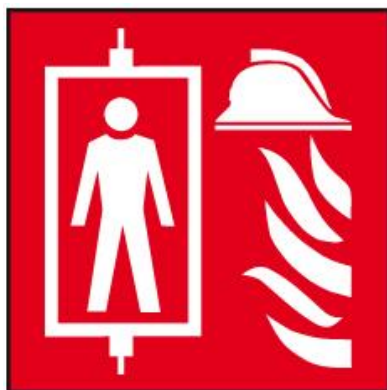
Obrázek 38 – Piktogram požárního výtahu (45)
