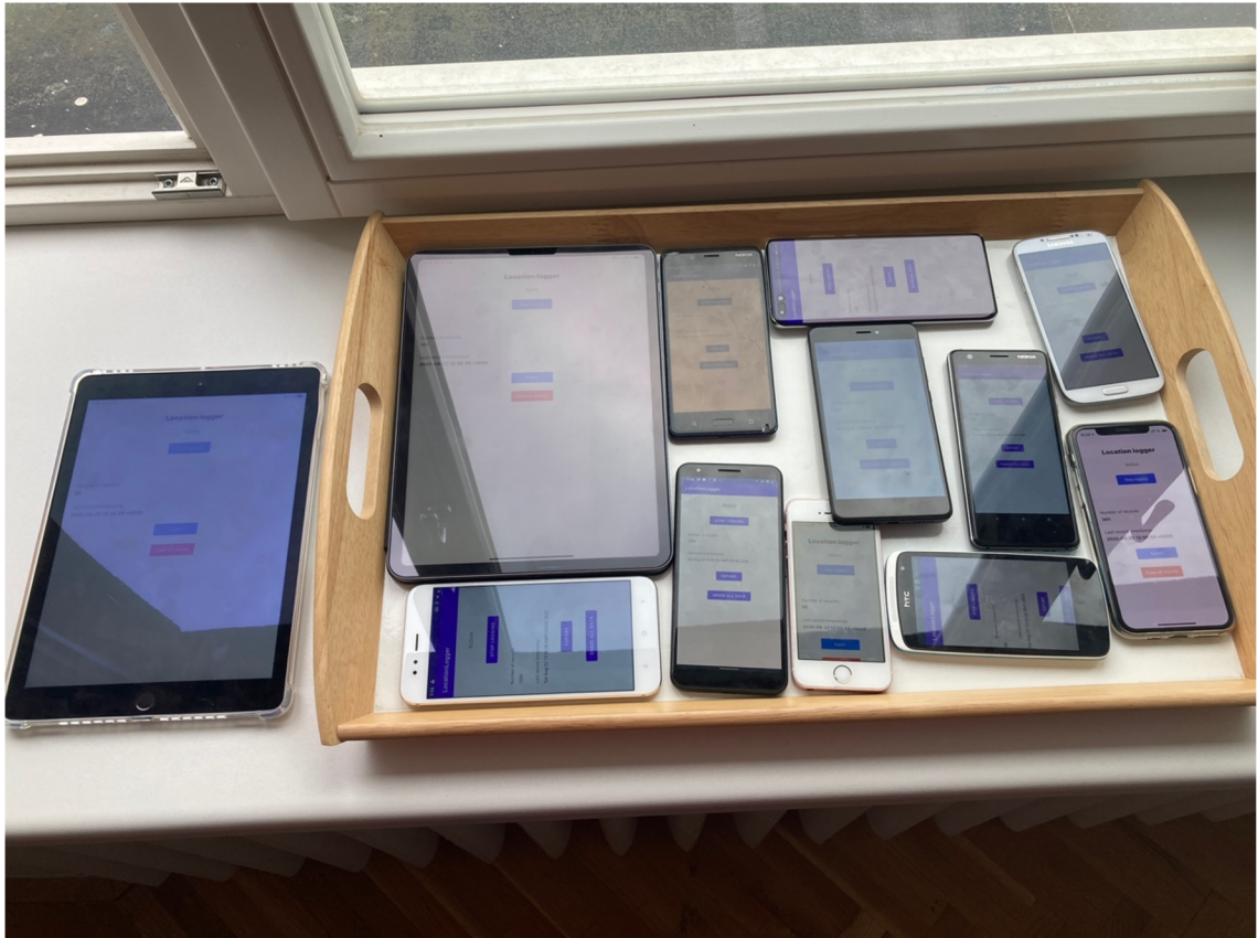
Obr. 17 Měření záznamů z GNSS senzorů zařízení
