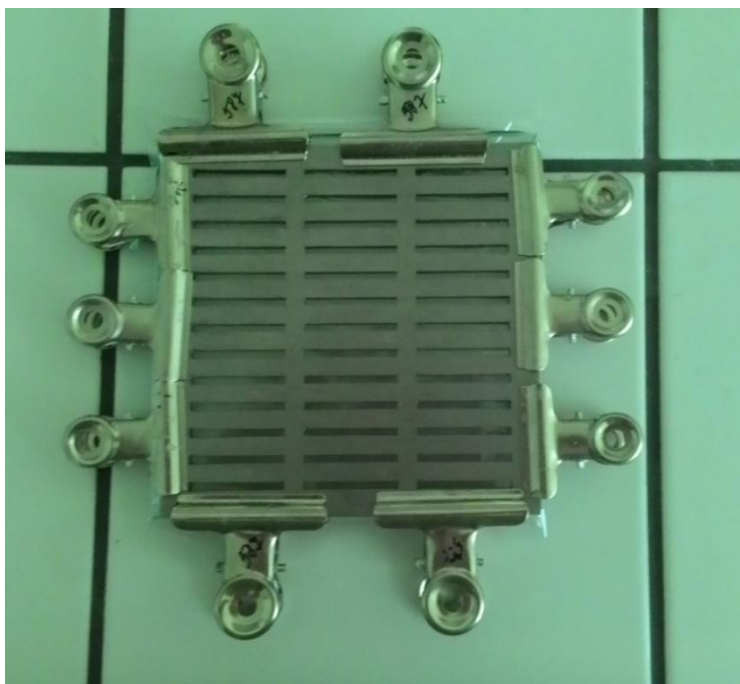
Obr. 15: Kovová forma pro přípravu testovacích trámečků
