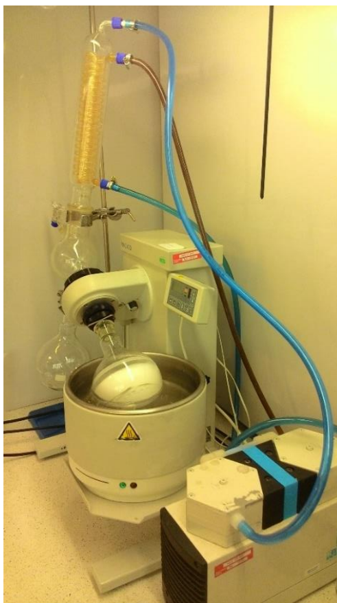
Obr. 14: Odpařování rozpouštědla na vakuové rotační odparce při druhém postupu silanizace
