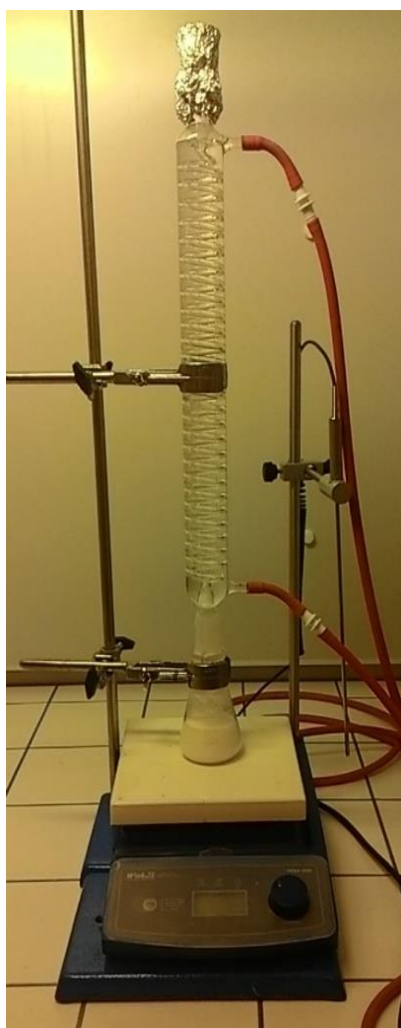
Obr. 13: Laboratorní aparatura pro refluxování při prvním postupu silanizace
