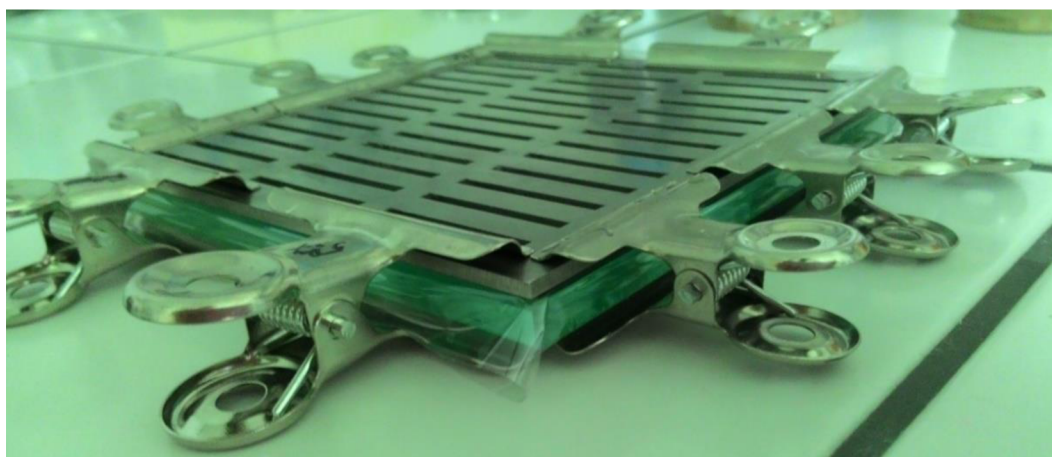
Obr. 16: Kovová forma připevněná na skleněné podložce s teflonovou folií
