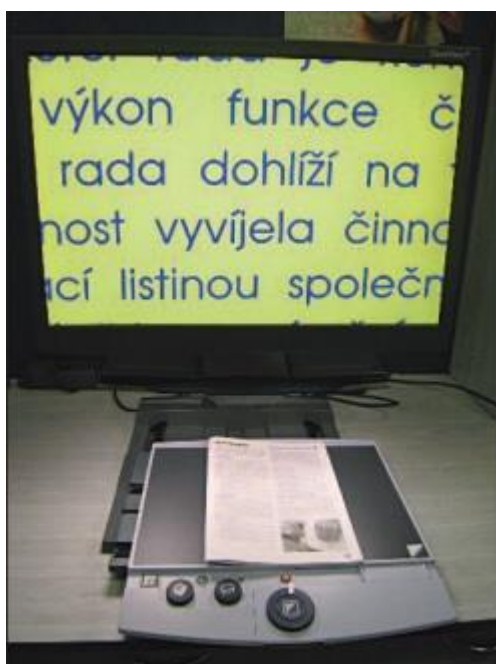
Obrázek č. 27 – Kamerová čtecí lupa nepřenosná (Zdroj: Karásek, 2012)
