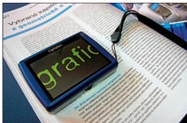
Obrázek č. 28 – Přenosná lupa Compact s vestavěným monitorem (Zdroj: Karásek, 2012)
