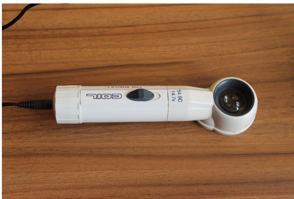
Obrázek č. 19 – Zvětšovací lupa se světlem a danou vzdáleností od textu
