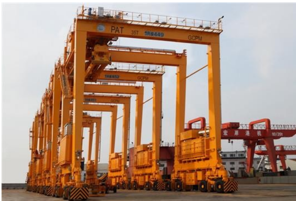
Obr. 1.8 Stohovací jeřáb RTG
