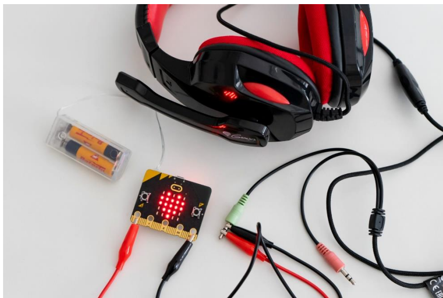
Obrázek 12: Připojení sluchátek pomocí krokosvorek (vlastní zpracování, 2023)
