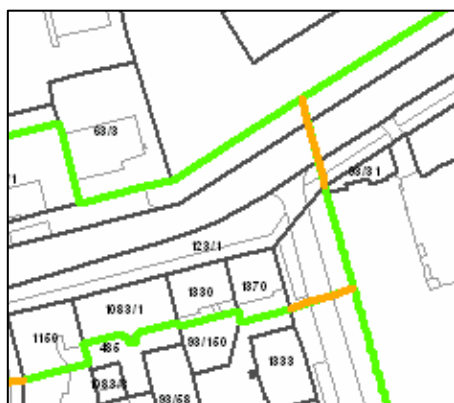
Obr. 19 Ukázka chyby hranice polygonu kříží komunikace, chodníky, vodní toky
